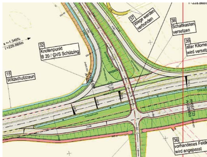
Bild 3 Draufsicht des Verkehrsknotenpunkts GVS/B20 bei Schützing Top view of traffic crossing road/highway B20 near Schützing
